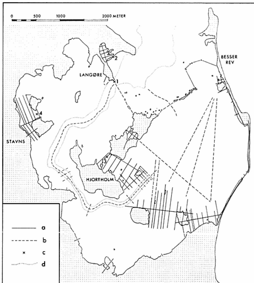
Fig. 1. Opmålingerne i Stavns Fjord 1964-65. a: nivelllement og pejling på højliggende flak samt nivelllement på marint forland, b: ekkolodning, c: strømmålingsstationer, d: Hjortholdsrenden, angivet ved det officielle søkorts  $\div 2$  m-kurve.
