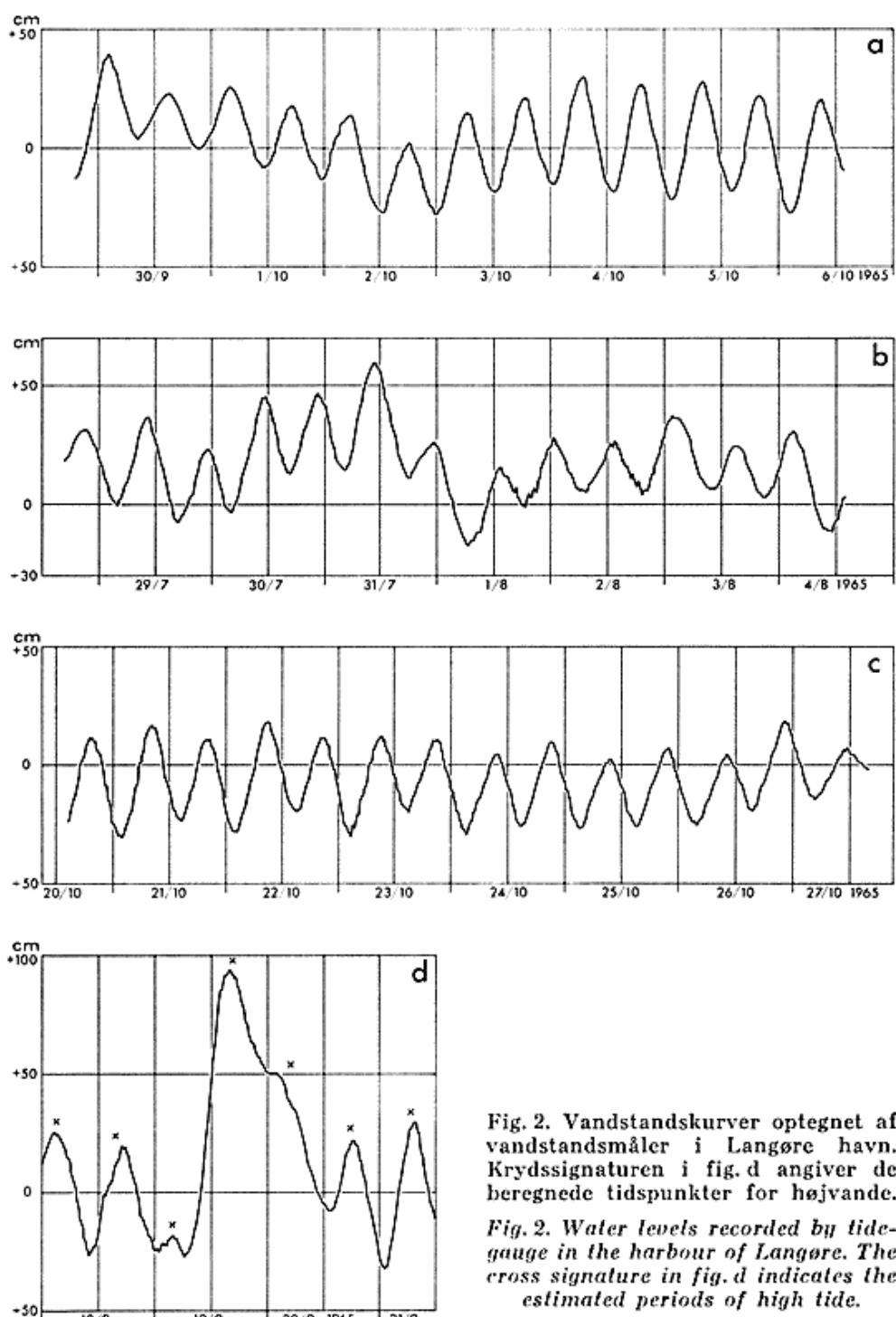
Fig. 2. Vandstandskurver optegnet af vandstandsmåler i Langøre havn. Krydssignaturen i fig. d angiver de beregnede tidspunkter for højvande.
